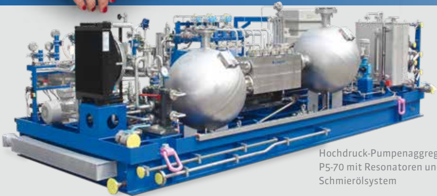
Hochdruck-Pumpenaggregat P3-96 für die Kohlemaischeförderung
